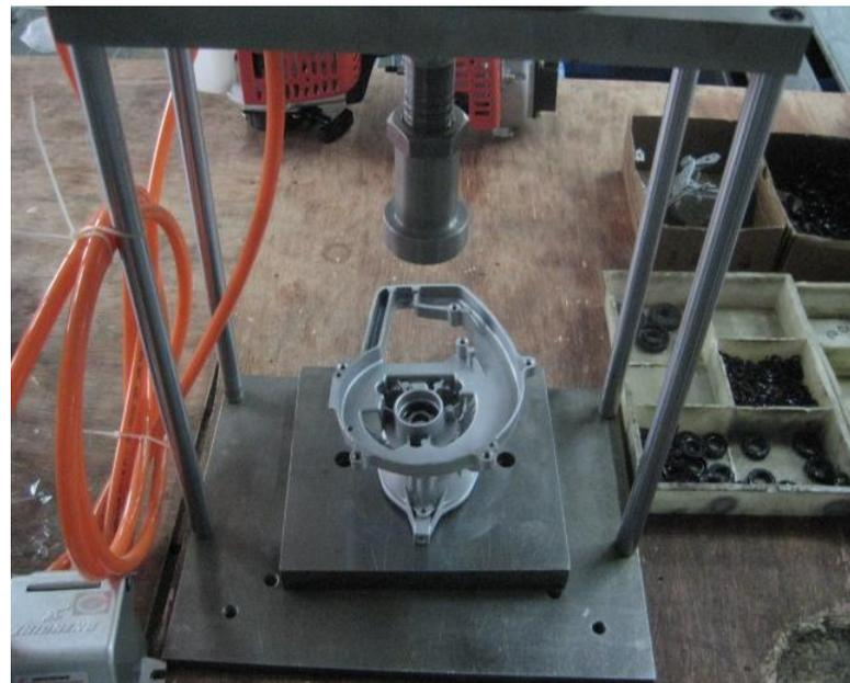
说明：原汽油机轴承油封用榔头敲入，作业强度大且易损伤油封，如上图设置压机后可避免上述不良发生并提高作业速度。
