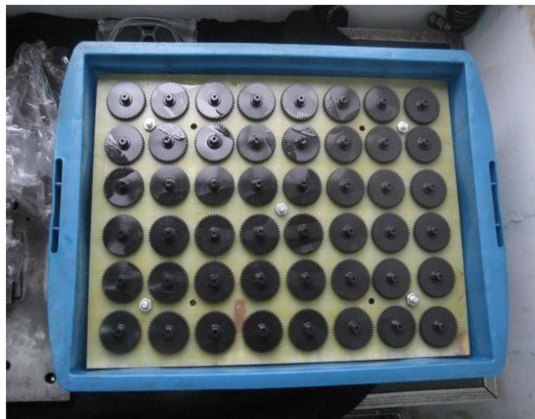
说明：按上图设置标准周转箱后，能够避免齿轮的磕碰现象（现由搬运过程引起的磕碰现象已消除），并实现定量管理及成套供应，简化仓储管理。
