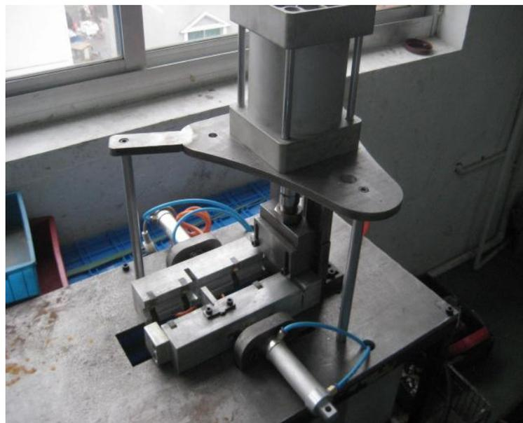
说明：按上图设置自动剪管机后，能够快速剪管，实现省人化，效率比原来提高30%以上。
