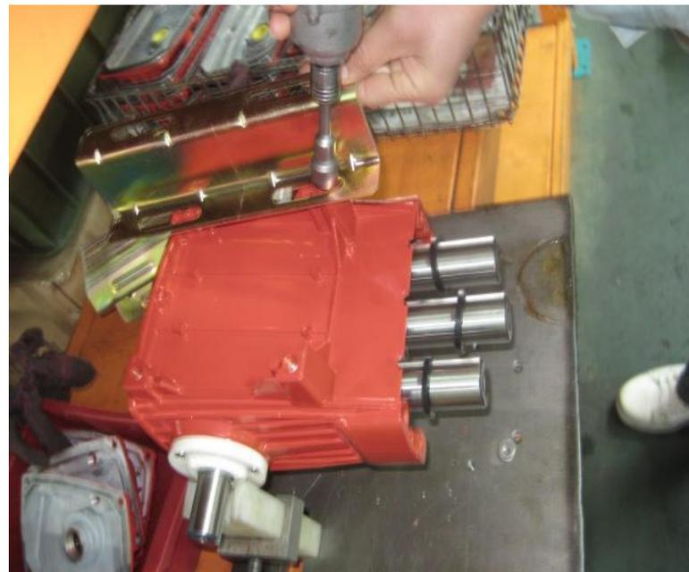
说明：设置工装前为单手扶紧作业，如上图设置工装后可实现双手作业，提高作业效率。
